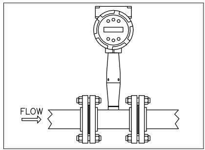
Figure 1-1. In-Line Vortex Multivariable Mass Flow Meter
